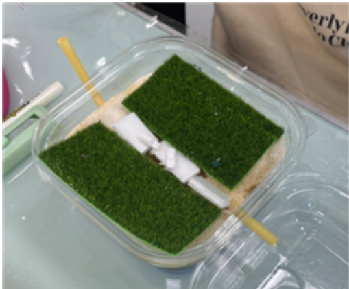
그림 1. 지하수 유출에 따른 공동 형성과 붕괴 과정을 재현한 지층 모형 실험
